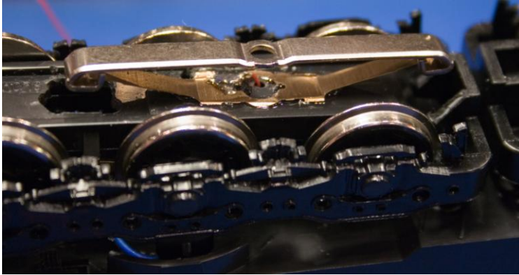
Bundpladen er genmonteret på bogien.
