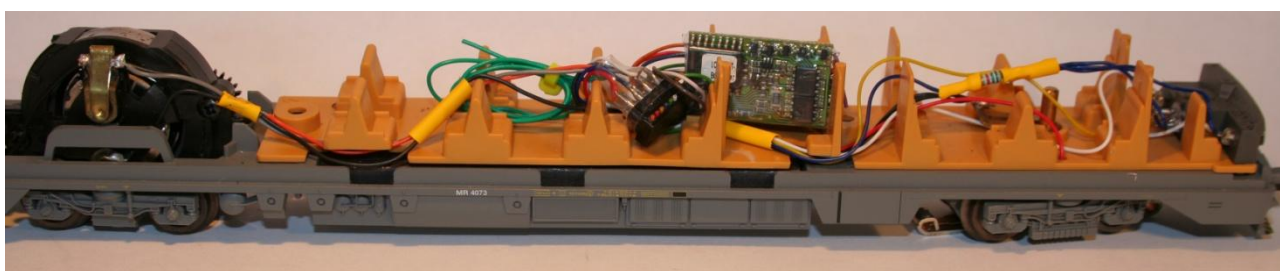
Figur 4-7: MR monteret med ESU LokPilot dekoder i NEM 652 stik
