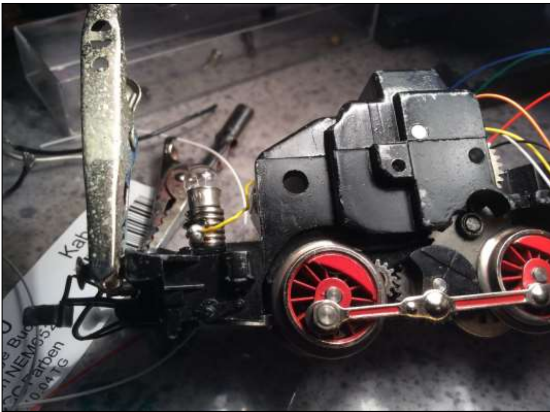
24. Og gul ledning fra kabeltræet loddet på bagerste lys (pære) i køreretningen.
