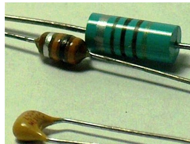
Støjdæmpning: Kondensator 100 nF Drosselspoler 10 \mu H
